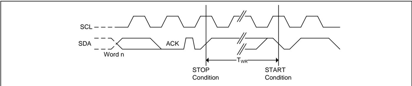
**Figure 5.8. Bus Timeout Waveform**
